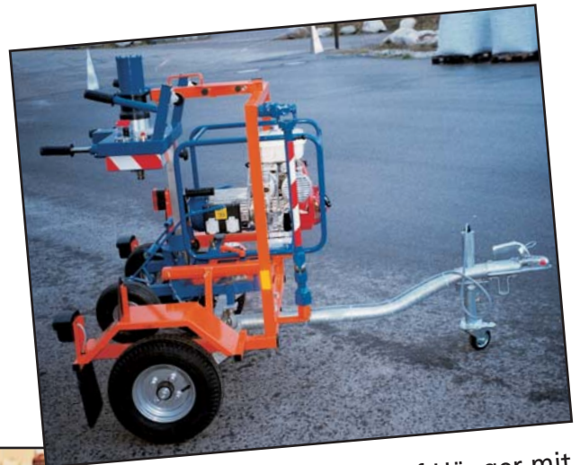
Wechselstrommaschine auf Hänger mit Aggregat innerhalb des Geräteträgers
