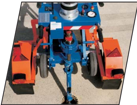
Abb. Maschine mit leicht aufsteckbarem Zusatzgetriebe 850 NM Ü= 2:1 (nur in Verbindung mit Hänger) für Schieber ab ca. DN 500
