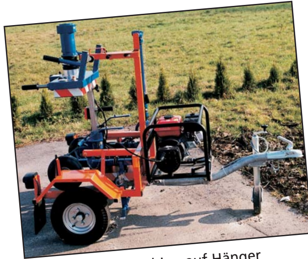
Wechselstrommaschine auf Hänger mit Aggregat auf Deichsel montiert
