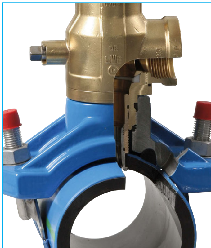
Kogel-ventiel aanboorarmatuur voor AC-, gietijzer- en stalen buis met opengesneden boorgathuls
